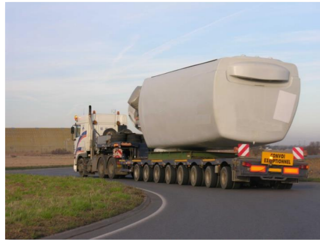
Photo 143 : Transport de nacelle (Photo : VALOREM)
